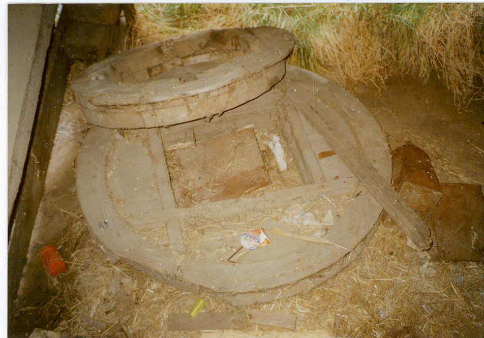
13. Fragmenty obudowy złoża przemiałowych, neg. 400/54/2.
