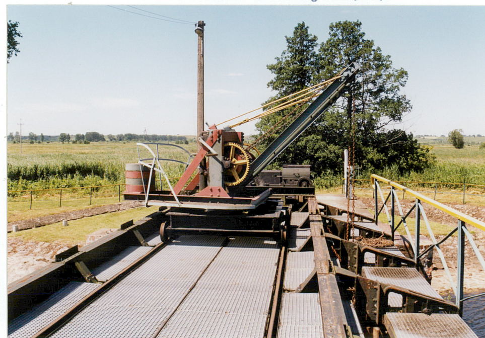
7. Wciągarka żurawiowa do podnoszenia zasuw i kładzenia słupków neg. 1100/213/5
