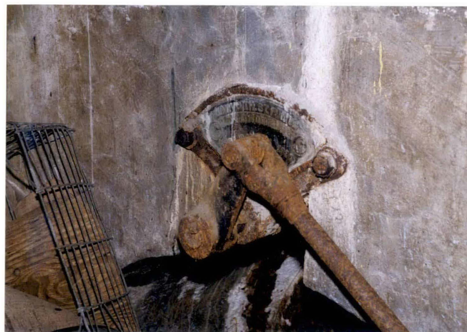
5. Mechanizmy regulacji turbiny wodnej, widoczny czytelny napis firmowy: J.M. Voith, St. Pölten, nr 10 450, 1930 r., fot. 99/32/6/1,
