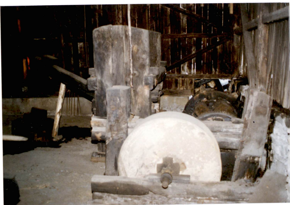
4. Widok młota naciskowego, widoczne wprowadzenie wału napędowego przez otwór w ścianie kuźni, neg. 500/840/4.
