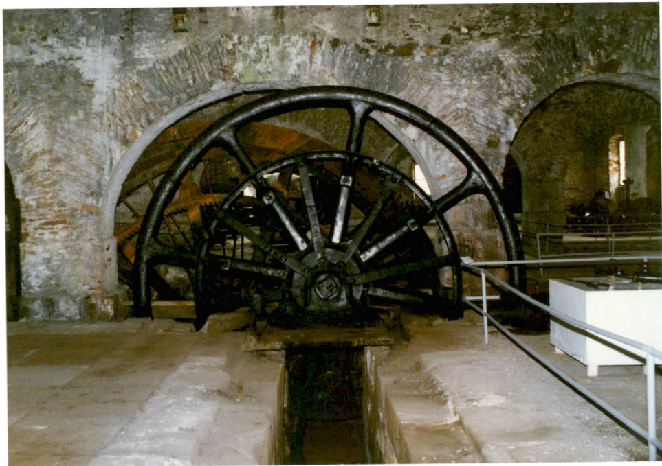
3. Kolo zamachowe współpracujące z kołem wodnym napędzającym walcownię (pozostałość oryginalnego wyposażenia), neg. 500/947/3.
