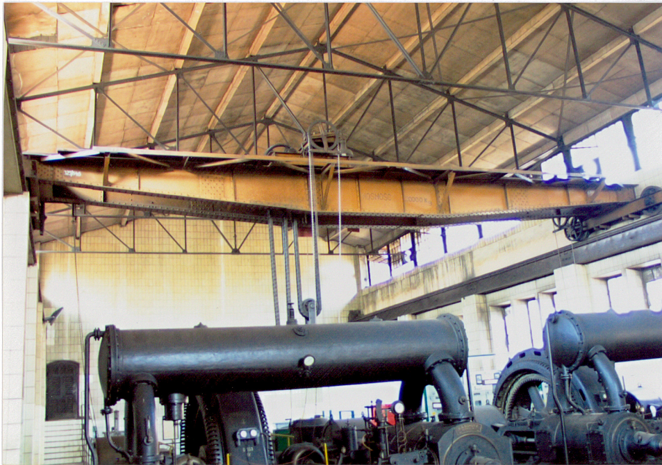
Widok wnętrza hali z suwnicą 20 000kg z ok. 1911 r
