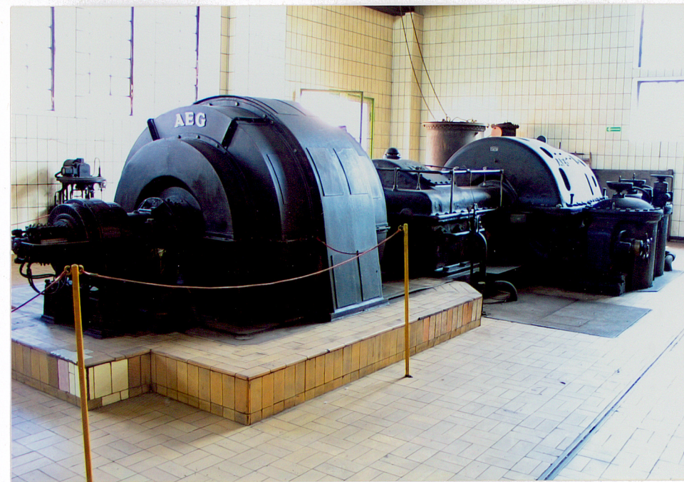
Widok silnika z turbokompresorem z 1939r produkcji AEG Berlin Widok turbokompresora z 1939r produkcji AEG Berlin
