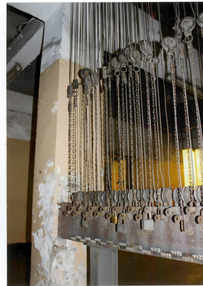
16.,17.,18. Mechanizm łańcusków na bloczkach do podwieszania haków na ubrania.
