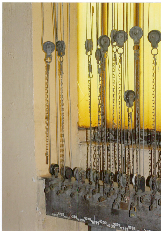
16.,17.,18. Mechanizm łańcusków na bloczkach do podwieszania haków na ubrania.
