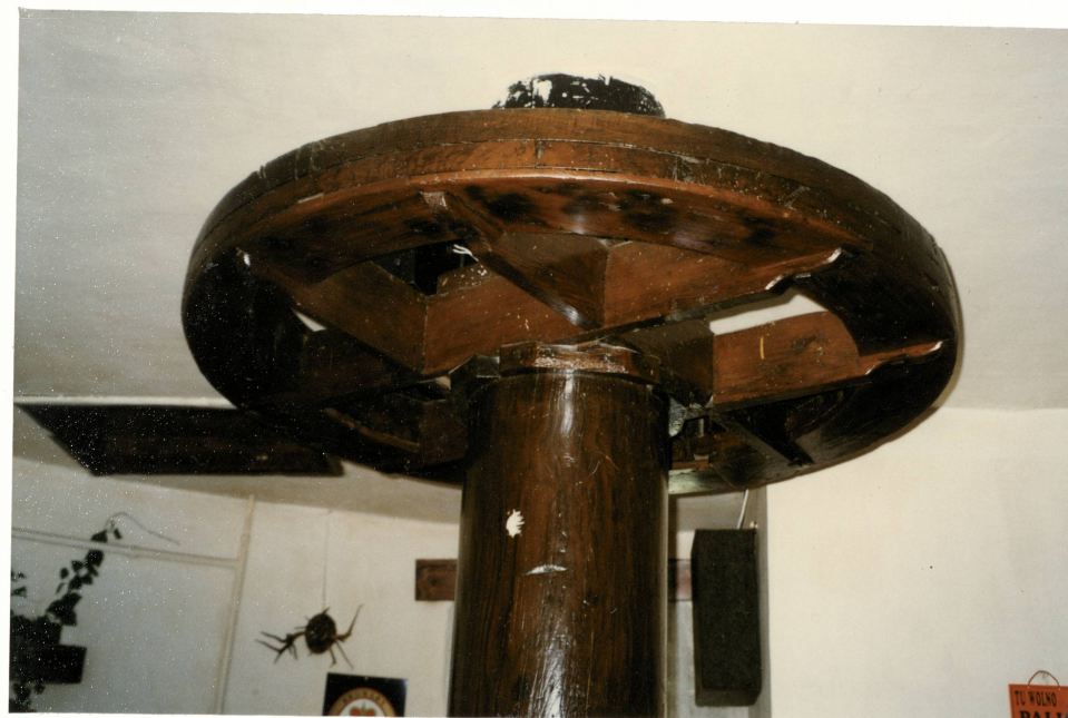
5. Koło przekładni pasowej układu przeniesienia napędu, neg. 600/521/5.
