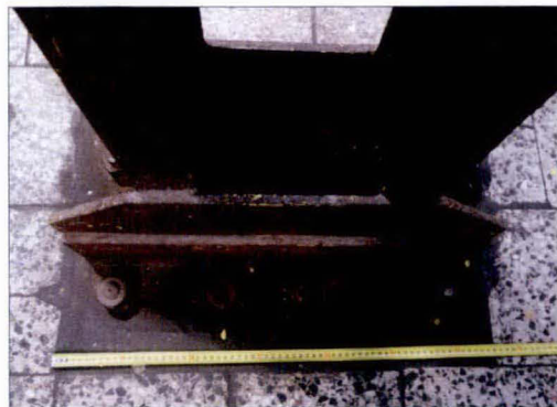
Podstawa i mocowanie do fundamentu słupa mostu suwnicy.
