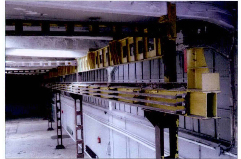
Most suwnicy z szyną jezdna oraz szynoprzewodem przy południowej ścianie hali.
