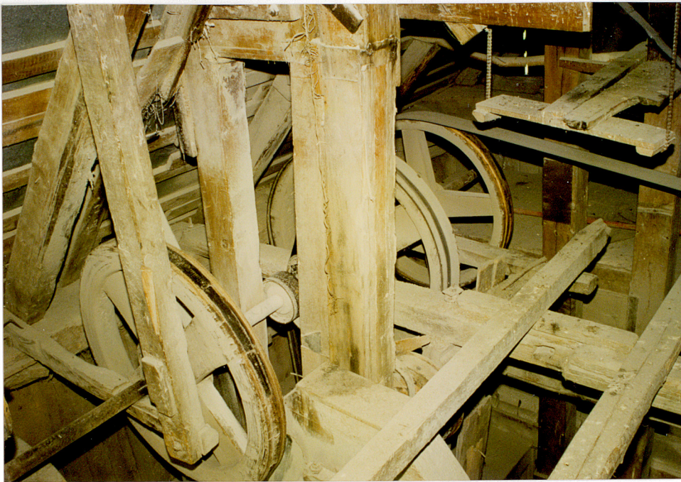
4. Wał pędni pasowej napędu windy na poddaszu wiatraka, neg. 700/355/5
