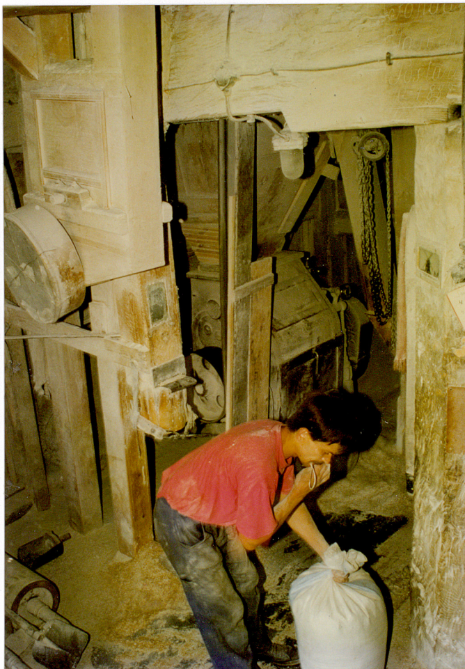
2. Mlewnik walcowy firmy Hipkow, workownica i transporter kubelkowy, neg. 700/355/1
