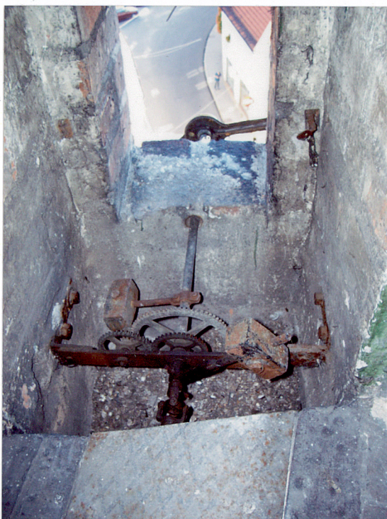
26. Mechanizm bocznych tarczy zegara.
