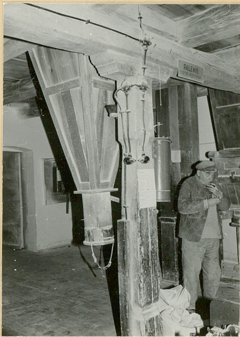
1. Mielnik zboża. 2. Mieszalka mączna. 3. Podnośnik mączny. 4. Zbiornik maki.
