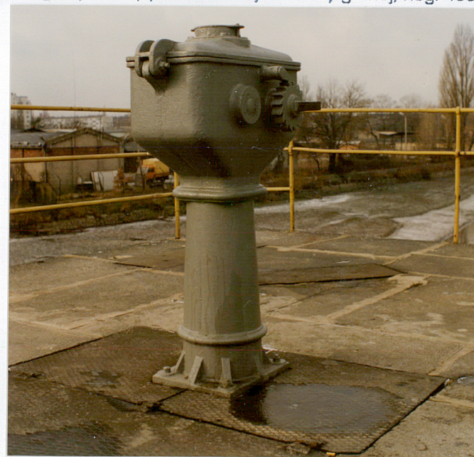
7. Ręczny mechanizm przekładniowy do otwierania i zamykania zasuw kanału obiegowego do uzupełniania stanu wody w zamkniętej części Kanału Miejskiego, neg 400/212/5
