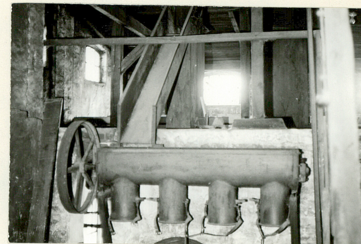
Workownica - część strychowa płatkarni
