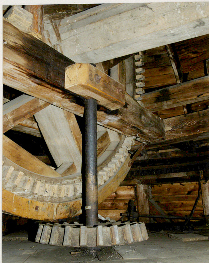
9. Koło palczaste - styk z wałem pionowym i poziomym
