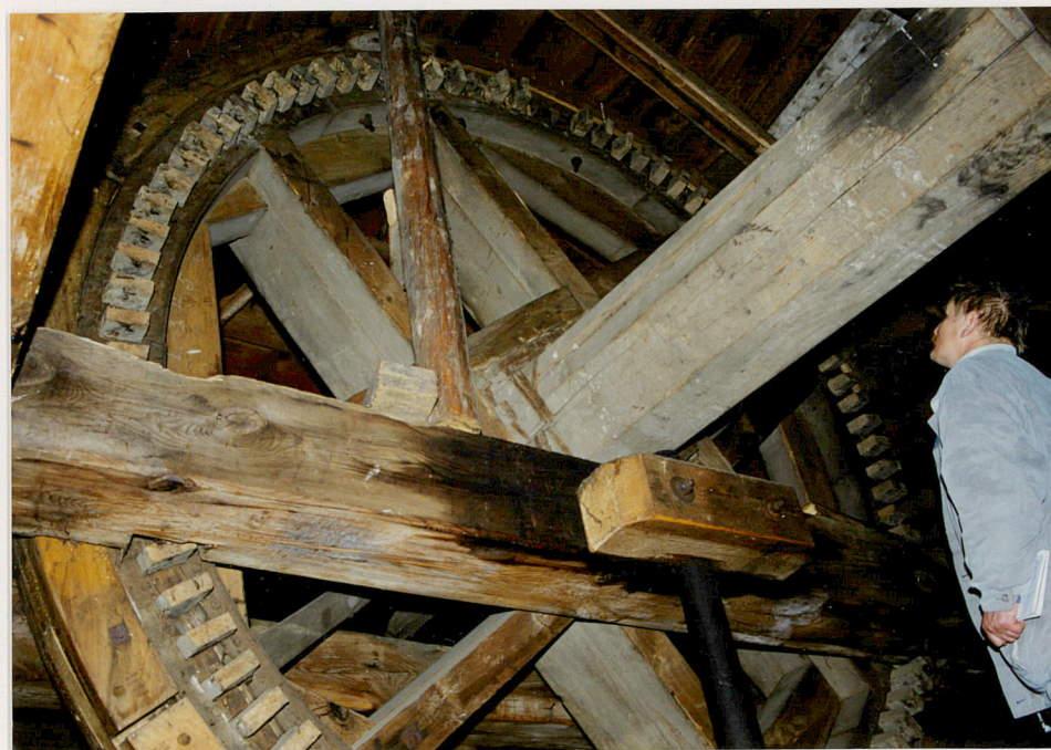
10. Koło palczaste - połączenie z wałem poziomym
