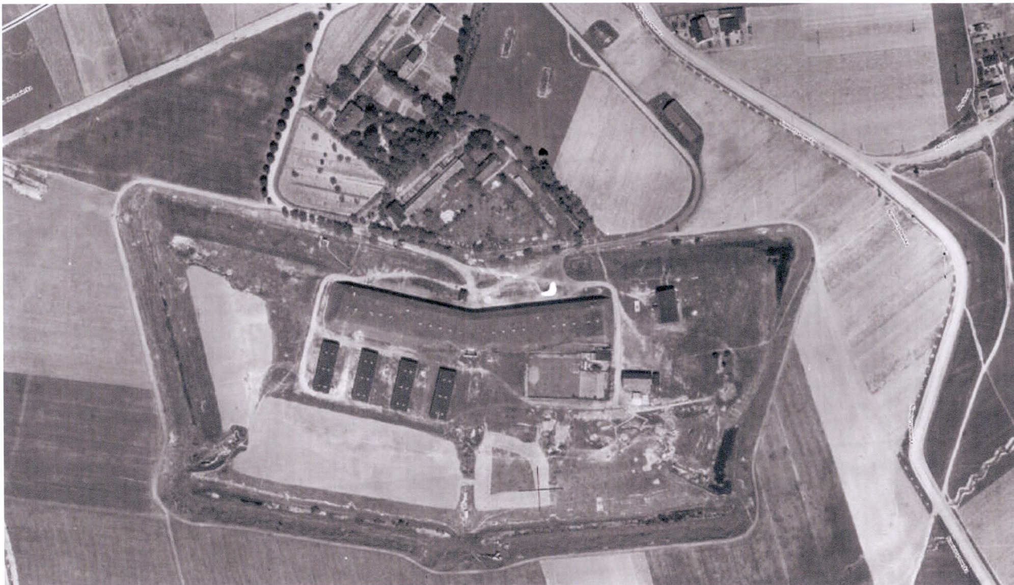
Ryc.5 Fort VIII w 1945 roku (fragment zdjęcia lotniczego www.warszawa1939.pl ). Świetnie są widoczne niesymetryczne drogi dojazdowe z obu stron rawelinu, i lodownia usytuowana przy wschodniej z nich. Widoczna jest zasypana fosa w środkowej części szyi, rozebrany tradytor i zniwelowany rawelin, wysadzone kaponiery w rowie fortecznym. Na dziedzińcu głównym cztery budynki zapewne stajni zbudowane podczas okupacji. Zwraca uwagę, iż już wtedy fosa lewego barku była mocno zdeformowana – podobnie jak i dziś.
