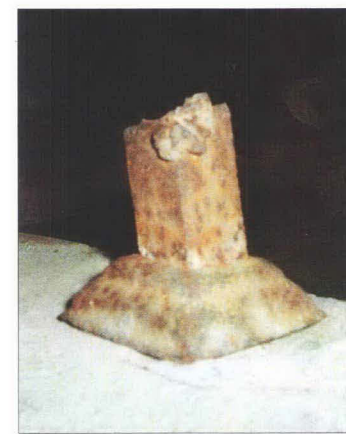
Dolny fragment pręta balustrady z ozdobną rozetą.
