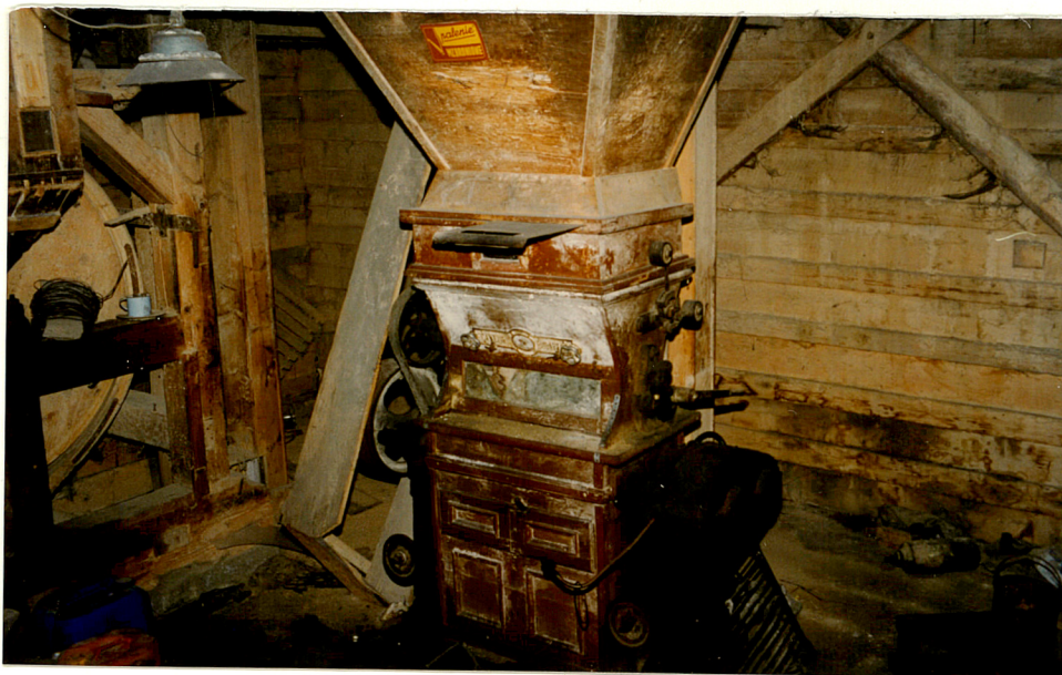
4. Mlewnik walcowy firmy Ganz z Budapesztu, neg. 700/635/3
