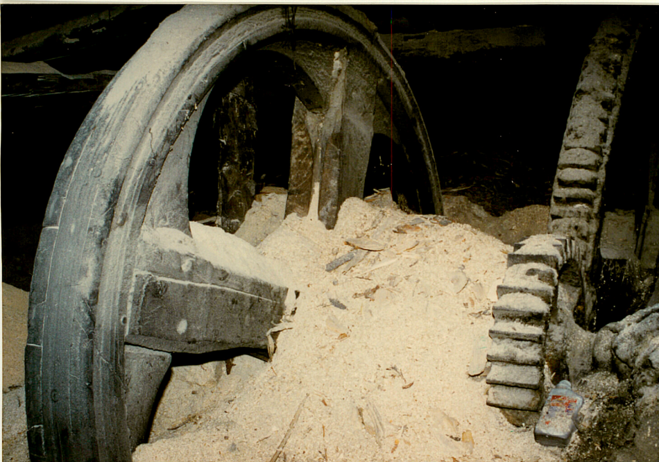
4. Przekładnia obrotów z koła wodnego na pędzie pasową traka z kołem balastowym, neg. 600/358/4
